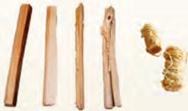
Legen Sie sich für einen emissionsarmen Start mind. vier trockene Tannenholz-scheite mit einem Querschnitt von ca. 3x3cm und einer Länge von ca. 20cm sowie Anzündhilfe (z. B. wachsextrahierte Holzwolle) zurecht.
